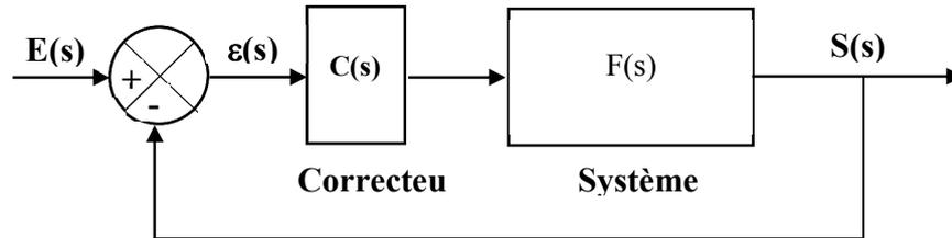
La fonction de transfert du système a été déterminée à partir de mesures en boucle ouverte :
